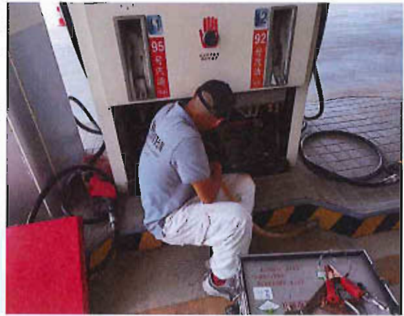
油气回收检测
